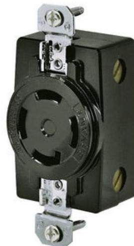
Dispositifs de verrouillage, Dispositifs de verrouillage, Industriel, Prise encastrée, 30A 3-Phase Wye 120/208V AC, 4-Pôles 4-Fils sans mise à la terre, Non-NEMA, Borne à vis, Noir.
