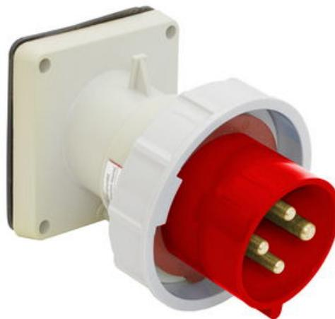
Produits pour usage intensif, dispositifs à broche et manchon IEC, qualité industrielle, entrée à bride mâle, 20A triphasé Wye 277/480V AC, 4 pôles 5 fils de mise à la terre, bornes à vis, rouge, étanche à l'eau.
