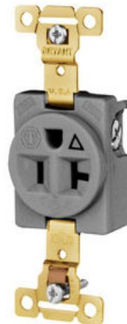
Dispositifs à lame droite, prises, simple, qualité commerciale/industrielle, mise à la terre 2 pôles 3 fils, mise à la terre isolée, 20A 125V, 5-20R, gris, paquet unique.
