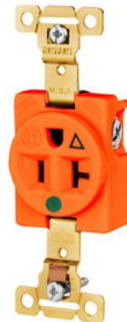
Dispositifs à lame droite, prises, simple, qualité hôpital, 20A 125V, 2 pôles, 3 fils, mise à la terre, câblage arrière et latéral, 5-20R, orange, paquet simple.
