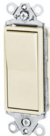
Interrupteurs et commandes d'éclairage, série Fashion de qualité industrielle, interrupteurs à bascule, usage général AC, trois voies, 20A 120/277V AC, câblage arrière et latéral, ivoire.
