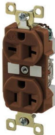
Dispositifs à lame droite, prises, Duplex, qualité commerciale/industrielle, 20A 125V et 250V, 2 pôles 3 fils avec mise à la terre, 5-20R et 6- 20R, marron, paquet unique.
