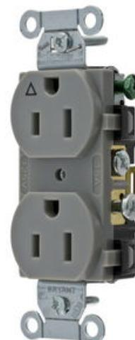
Dispositifs à lame droite, prises, Duplex, qualité commerciale, 15A 125V, 2 pôles, 3 fils de mise à la terre, 5-15R, gris, paquet unique, mise à la terre isolée.
