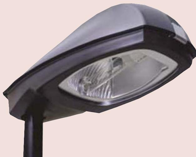
Starline имеет уникальную систему отражателей, которая обеспечивает оптимальное расстояние между конструкциями, используя лампы мощностью 100-400 Вт. Корпус алюминиевого сплава морского класса подходит для использования в прибрежных и атмосферных средах, а герметичная оптическая система эффективно предотвращает от попадания пыли и грязи, а также обеспечивает эффективные характеристики освещения дороги и периметра.
