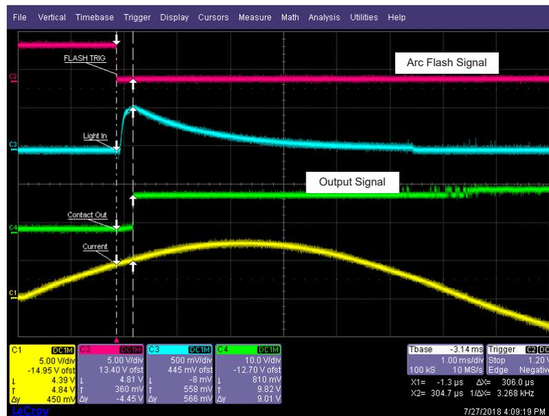
Figura 7 Ejemplo de Velocidad de Disparo de Salidas de Arco eléctrico (flash a 45° de 5 A de corriente –  $\Delta t = 306$  μs)
