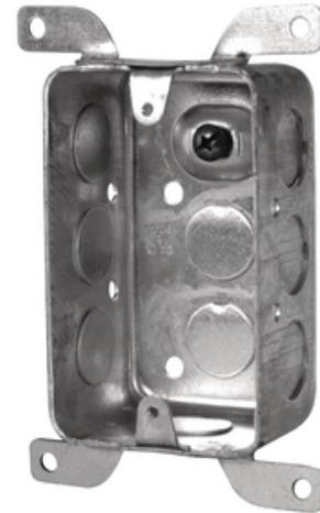
Boîte utilitaire, 1-7/8 po. Profondeur, 16.5 Cu. po, avec vis de mise à la terre surélevée, 1/2 po KO (paquet de 50). KO (paquet de 50).
