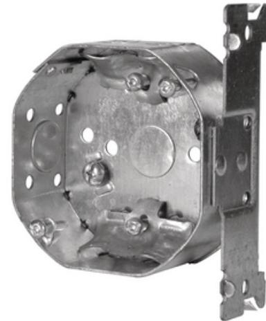
Boîte octogonale de 4 po, 1 1/2 po de profondeur, 15 po cu.
