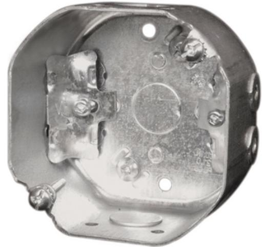
Boîte octogonale de 4 po, 2-1/8 po de profondeur, 21 cu. Profondeur, 21 Cu. po, pour ventilateur de plafond et appareil d'éclairage de 35 lb, 1/2 po KO, ouvertures pour câbles, vis de mise à la terre surélevée, NMD90 (paquet de 10). KO, ouvertures pour câbles, vis de mise à la terre surélevée, NMD90 (paquet de 10).
