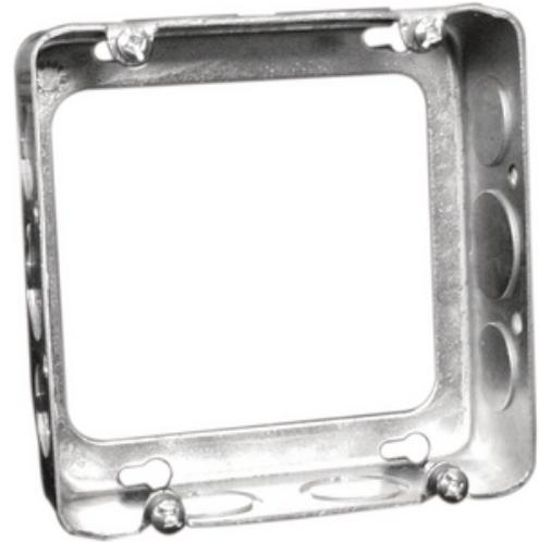
Anneau d'extension pour boîte carrée de 4-11/16 po, 1-1/2 po de profondeur, 42 po cu. Profondeur, 42 Cu. po, avec concentrique, 1/2 et 3/4 po, et 1/2 po KO (paquet de 25). KO (paquet de 25).
