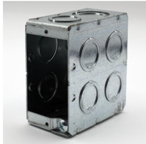
Boîte de maçonnerie, 3-1/2 in. Profondeur, 21 Cu. po, boîte à maçonnerie 1 groupe, largeur de 2 po, hauteur de 3-3/4 po, vis à sol surélevée, avec vis concentriques de 1/2 et 3/4 po. Largeur, 3-3/4 Hauteur, Vis à sol surélevé, avec Concentrique, 1/2 & 3/4 po KO (paquet de 20). KO (paquet de 20).
