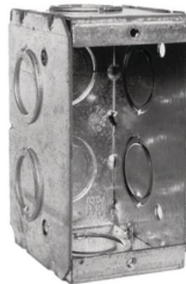
Boîte de maçonnerie, 2-1/2 in. Profondeur, 14 Cu. po, boîte à maçonnerie 1 groupe, largeur de 2 po, hauteur de 3-3/4 po, vis à sol surélevée, avec vis concentriques de 1/2 et 3/4 po. Largeur, 3-3/4 Hauteur, Vis à sol surélevé, avec Concentrique, 1/2 & 3/4 po. KO (paquet de 20).
