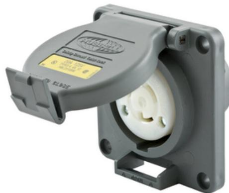
Prise Safety-Shroud® étanche Twist-Lock®, 20A 125V, 2-pôles, 3-fils avec terre, NEMA L5-20R, logement et bride PBT.
