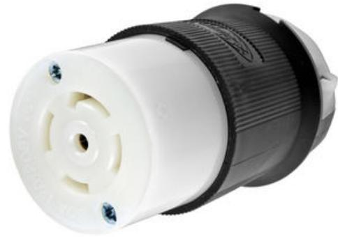
Connecteur Twist-Lock® Insulgrip®, 30A, 3 phases Y 120/208V AC ; 4 pôles, 5 fils de mise à la terre, NEMA L21 et blanc pour câble plat.
