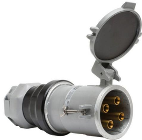
Dispositifs Insulgrip à broche et manchon à usage intensif, corps de connecteur femelle de qualité industrielle, 100A 600V CA, 2-pôles 3-fils avec mise à la terre style 2, vis de connexion.
