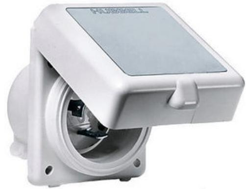
Dispositifs de verrouillage, Twist-Lock®, qualité marine, entrée de coque, 32A 230V AC 50 cycles, mise à la terre 2 pôles 3 fils, international, borne à vis, blanc.
