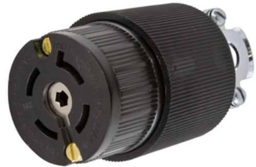
Dispositifs de verrouillage, Twist-Lock®, Variload®, corps de connecteur femelle, 30A 250V DC/600V AC, 50 - 400 Hz 4-pôles 5-fils de mise à la terre, non-NEMA, borne à vis, corps noir non métallique, broche centrale unique.
