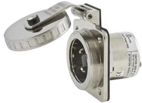
Dispositifs de verrouillage, Twist-Lock®, qualité marine, prise de courant de quai, 50A 125/250V, 3 pôles 4 fils avec mise à la terre, non NEMA, borne à vis, laiton chromé.
