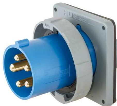
Entrée à bride mâle de qualité industrielle à broche et manchon CEI, 60A triphasé, 120/208V CA, 4-pôles, 5-fils, mise à la terre, bornes à vis, étanche à l'eau.
